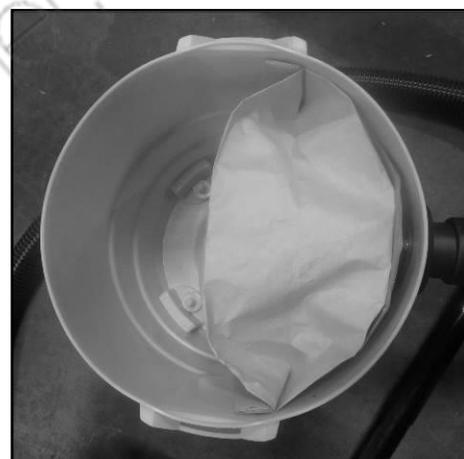
Figura 10 – Montaggio filtro aspirazione polveri.
