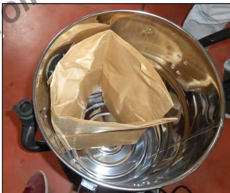
Figura 8 – Montaggio sacchetto di raccolta polveri.
