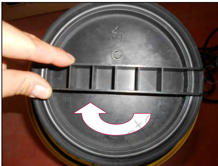
Figura 7 – Montaggio filtro dell'aria.
