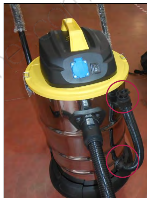
Figura 11 - Inserimento tubo di scarico.
