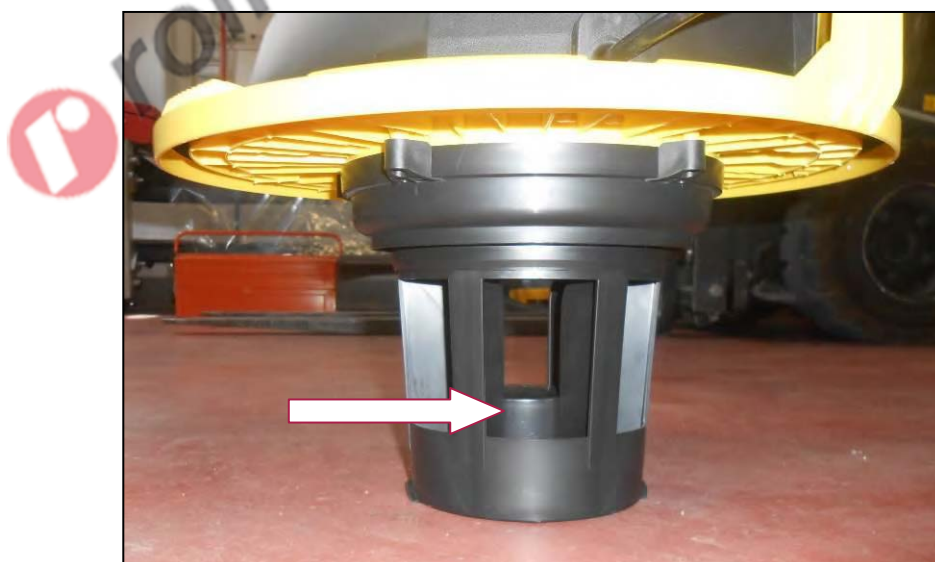
Figura 10 – Galleggiante di sicurezza.
