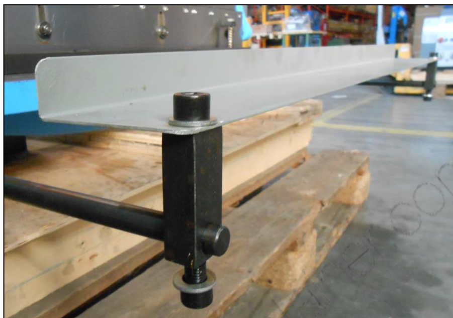
Figura 6 - Collegamento della battuta posteriore.
