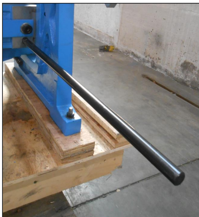
Figura 7 - Posizionamento delle barre di sostegno della battuta anteriore.
