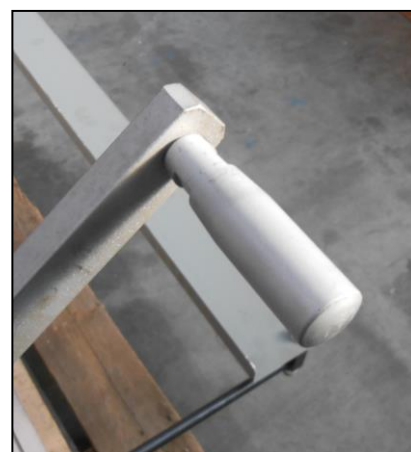
Figura 9 - Pomolo per la movimentazione della leva.
