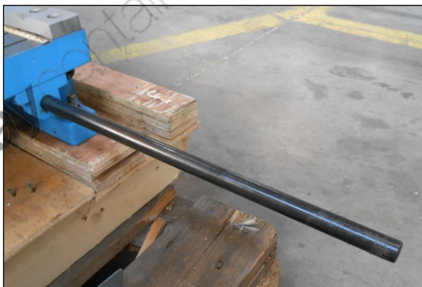
Figura 4 - Posizionamento delle barre di sostegno della battuta posteriore.
