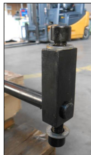
Figura 4 - Posizionamento delle barre di sostegno della battuta posteriore.
