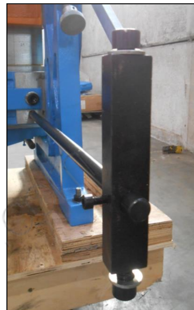
Figura 8 - Fissaggio degli elementi di collegamento della battuta.
