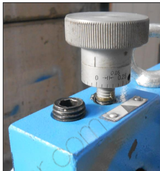
Figura 11 - Pomolo di regolazione della compressione sulla lamiera e grano per l'estrazione del rullo.
