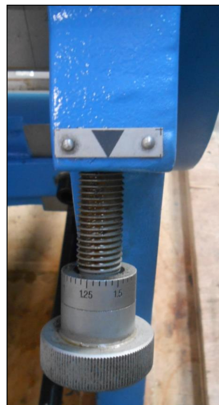
Figura 10 - Pomolo di regolazione diametro/cono della Calandra.
