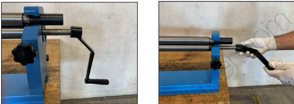
Figura 8 – Manovella di azionamento diretto calandra.
