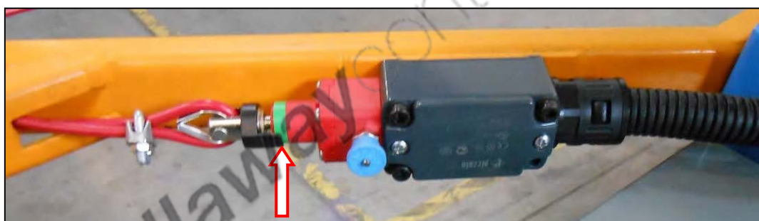
Figura 7 – Micro, pulsante azzurro e leva di sgancio in posizione corretta (armato).
