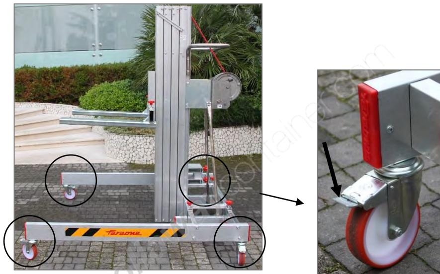
**NOTA:** Per bloccare il freno delle ruote, premere con forza la leva, facendo uso della punta del piede, in modo che rimanga in posizione tutta bassa.
