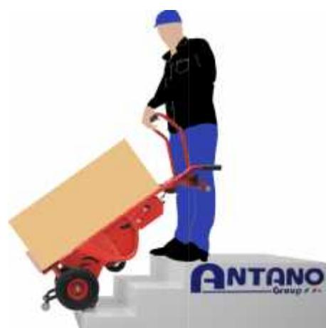
9. Al termine della rotazione delle ruote di sollevamento le ruote di spostamento vanno in appoggio sul gradino.
