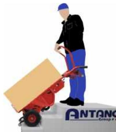
12. Al termine della scala, prima dell'ultimo gradino, impugnare i manubri ed intraprendere l'ultimo gradino agendo sul pulsante di salita del manubrio.
