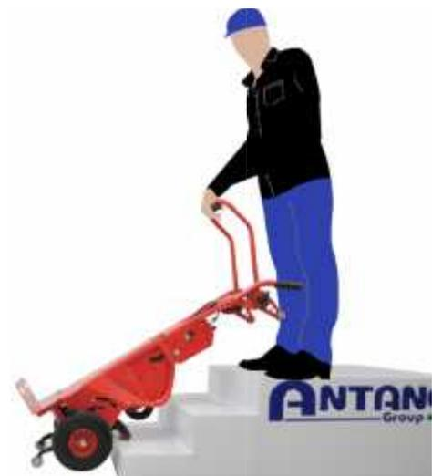
9. **Il carico è ammissibile** se la macchina è riuscita a superare il primo gradino senza sbilanciamenti in avanti.
