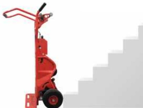
6. Impugnando il timone, inclinare la macchina fino ad appoggiare la ruota centrale di appoggio sul gradino. L'operatore si deve posizionare almeno due gradini sopra le ruote della macchina.
