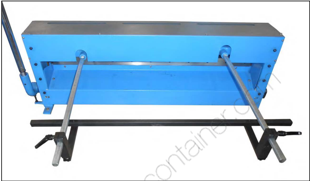
Figura 6 – Battuta posteriore correttamente montata.
