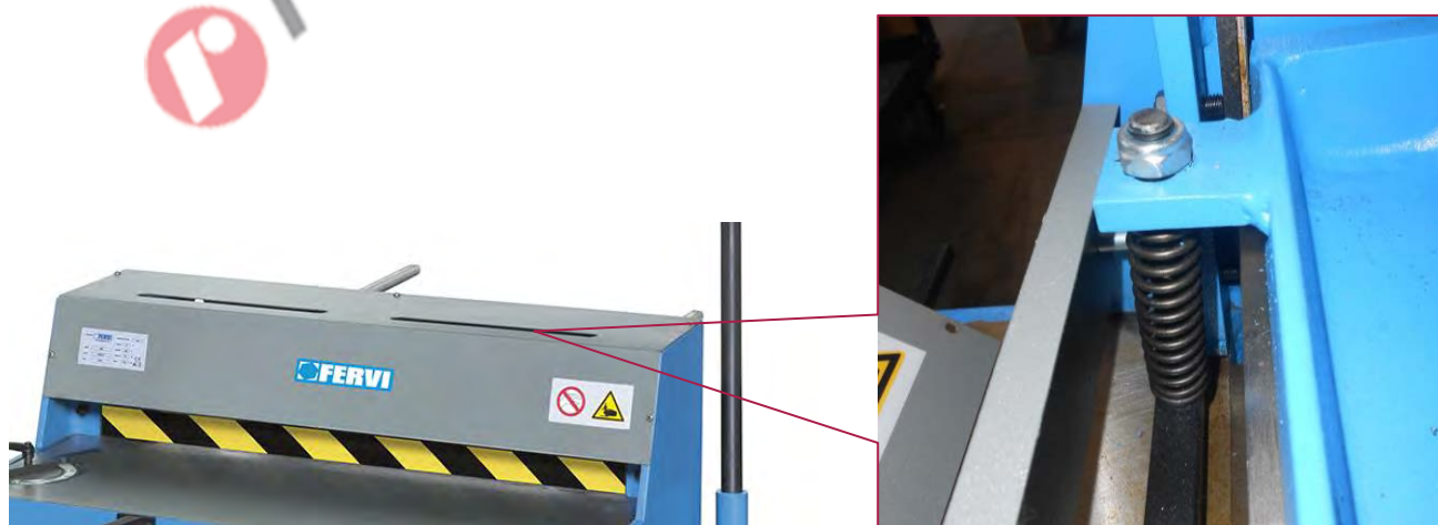
Figura 13 – Viti di regolazione della battuta ferma pezzo.
