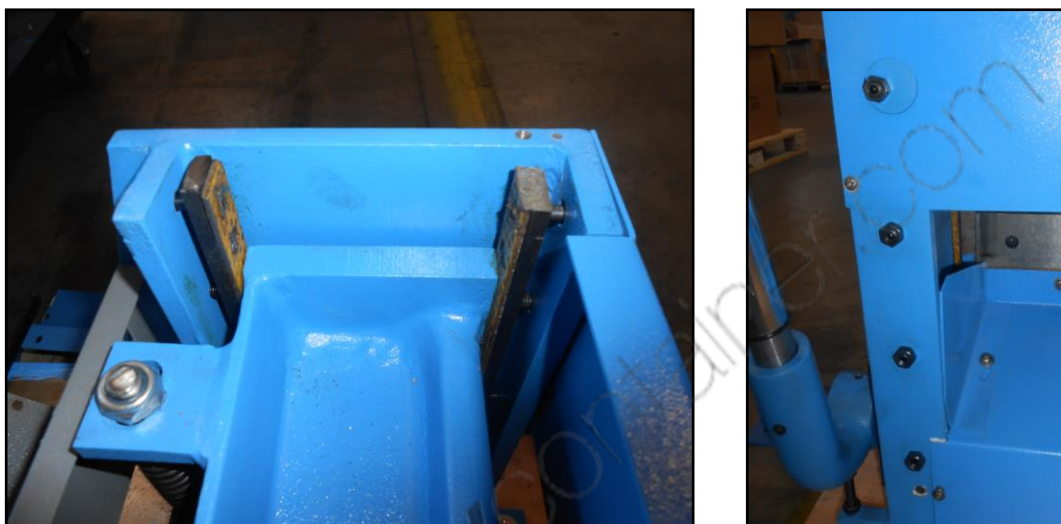
Figura 12 – Guide scorrimento lama e relative viti di regolazione.
