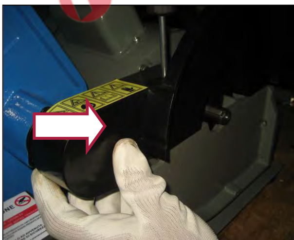
Figura 5 – Carter fissi della levigatrice.
