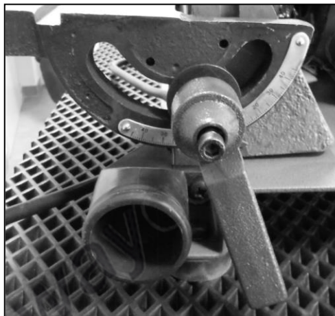
Figura 17 – Regolazione del goniometro.
