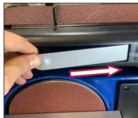
Figura 12 – Rilascio della tensione.
