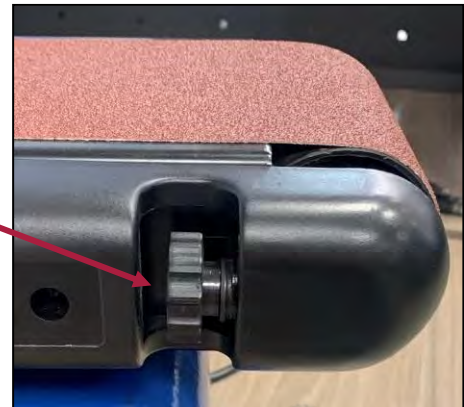
Figura 15 – Allineamento del nastro abrasivo.
