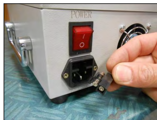
Figura 5 – Fusibile di protezione del circuito elettrico.
