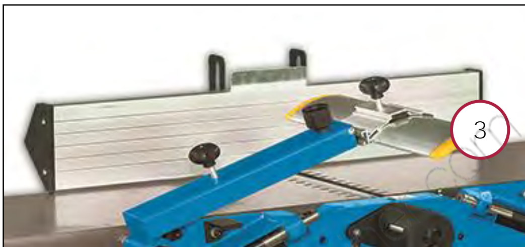
Figura 7 – Ripari dell'albero della pialla.
