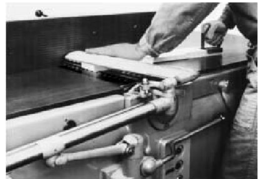
Figura 17 – Piallatura di pezzi corti.
