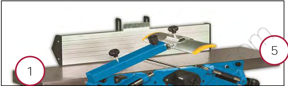
Figura 8 - Tavole di piallatura "a filo".
