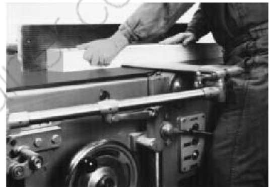
Figura 16 – Piallatura di pezzi di spessore maggiore.
