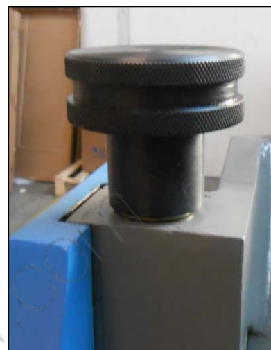
Figura 5 - Pomolo di regolazione dell'altezza del coltello superiore.
