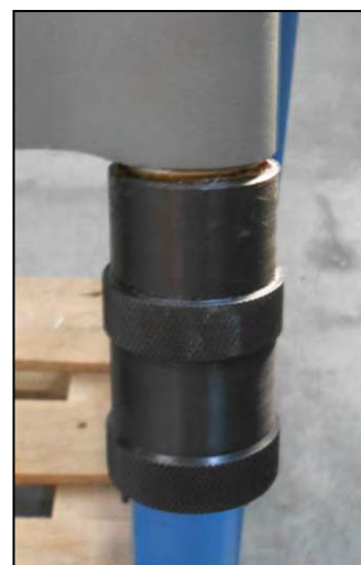
Figura 6 - Pomolo di regolazione dell'altezza del coltello inferiore.
