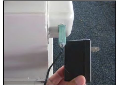
Figura 4 – Connessione del trasformatore.
