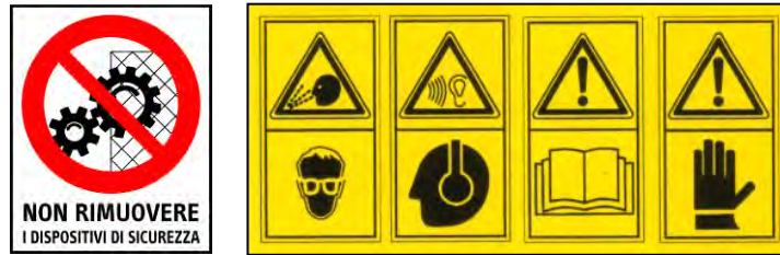
Figura 4 - Pittogrammi di divieto e pericolo.
