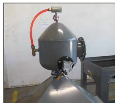
Figura 11 - collegamento del serbatoio dell'abrasivo alla tramoggia.
