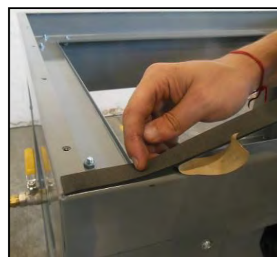
Figura 10 - Montaggio isolante sulla staffa.
