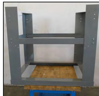
Figura 8 - Montaggio rinforzi alle gambe.
