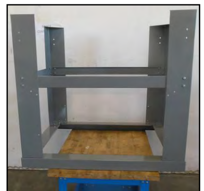
Figura 5 - Montaggio rinforzi alle gambe.
