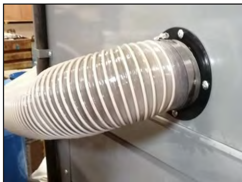
Figura 14 – collegamento dell'aspiratore alla sabbiatrice.
