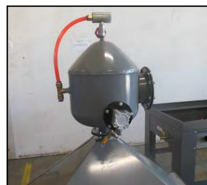
Figura 8 - collegamento del serbatoio dell'abrasivo alla tramoggia.
