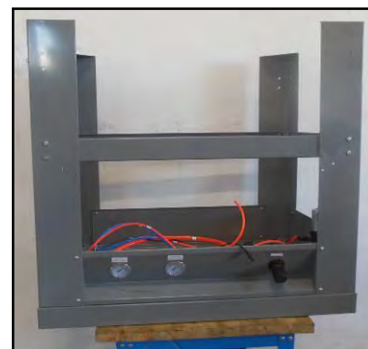
Figura 6 - Montaggio placche comandi e rubinetto aria compressa.
