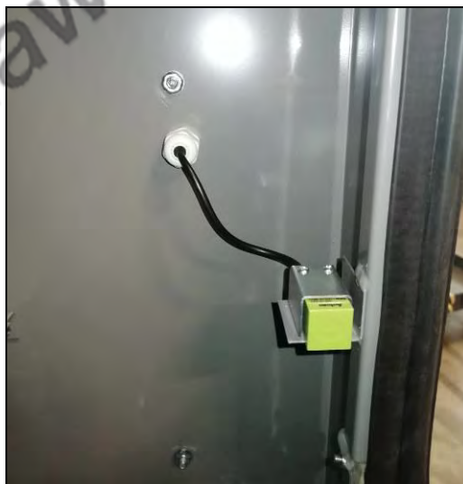
Figura 21 Interruttore micro magnetico di sicurezza
