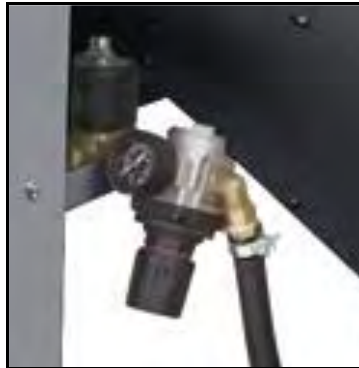
Figura 10 – Attacco dell'aria compressa.
