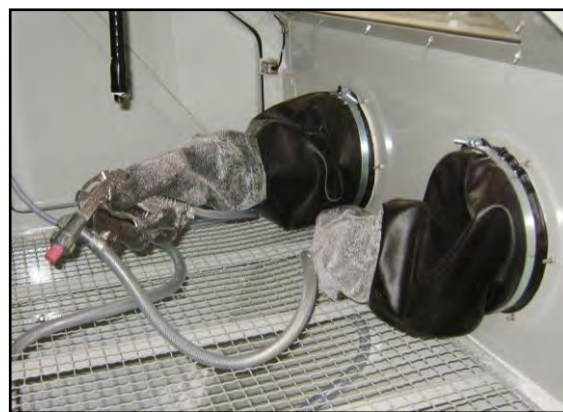
Figura 17 – Sabbicare con la pistola.
