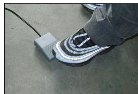
Figura 18 – Premere il pedale per sabbare con l'ugello fisso.
