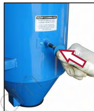
Figura 25 – Premere l'asta sul fianco dell'aspiratore.
