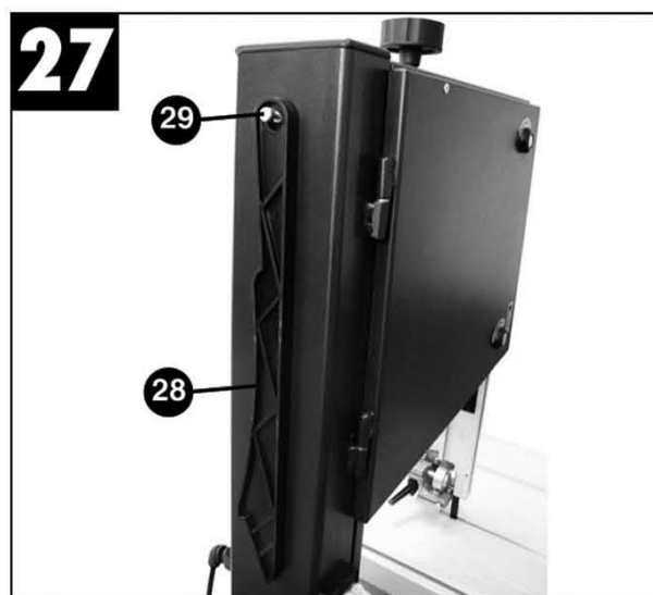
Figura 8 – Montaggio supporto spingipezzo.
