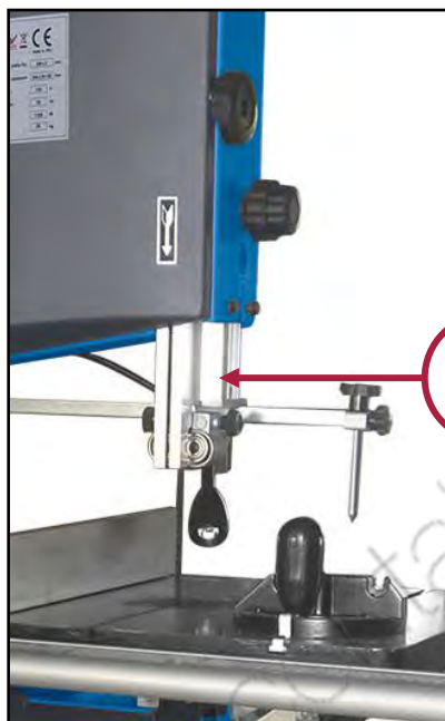
Figura 22 – Carter regolabile di protezione lama.
