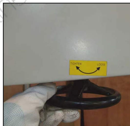
Figura 10 – Regolazione della tensione della lama.
