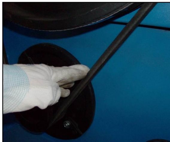
Figura 41 – Cinghia di trasmissione della sega.
