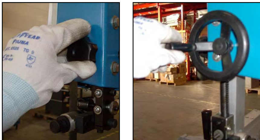
Figura 9 – Sblocco e regolazione del riparo.
