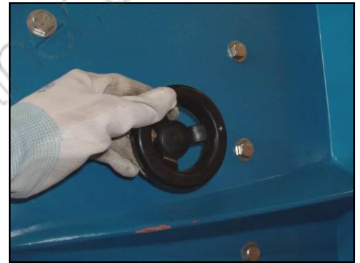
Figura 12 – Regolazione inclinazione puleggia.
