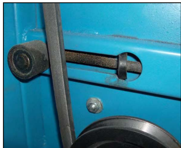
Figura 39 – Regolazione della tensione della cinghia.
