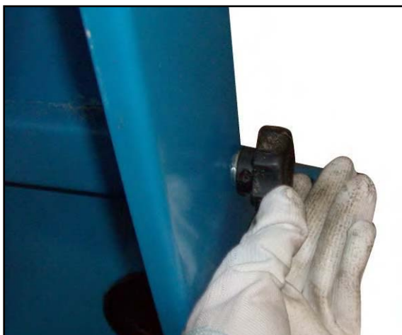
Figura 39 – Regolazione della tensione della cinghia.
