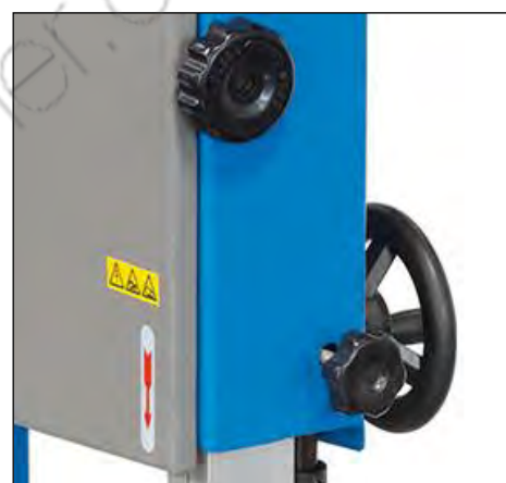
Figura 34 – Apertura serratura portello.
