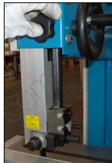
Figura 15 – Carter di protezione lama.
