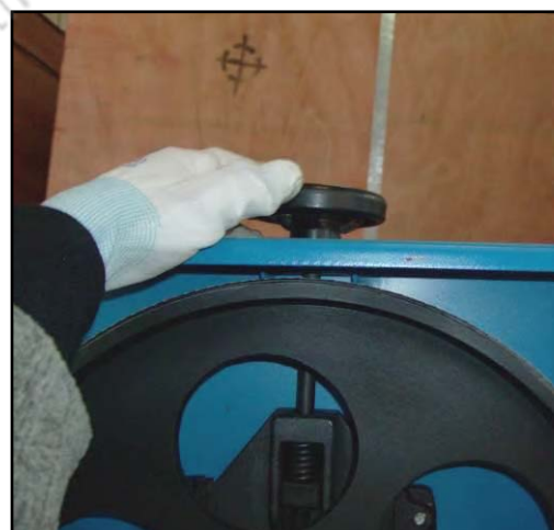
Figura 10 – Regolazione della tensione della lama.
