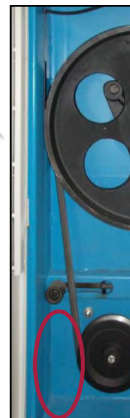
Figura 40 – Bulloni di fissaggio del motore elettrico.
