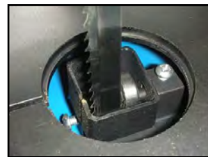
Figura 25 – Dettaglio guida lama inferiore.
