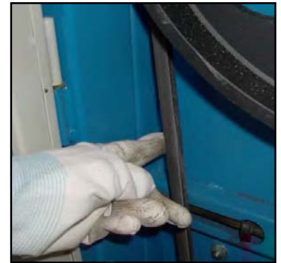
Figura 37 – Cinghia di trasmissione della sega.
