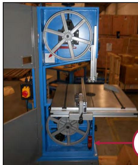
Figura 13 – Riparo mobile vano pulegge.
