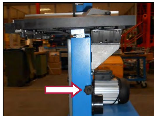
Figura 25 – Allentamento della cinghia di trasmissione.
