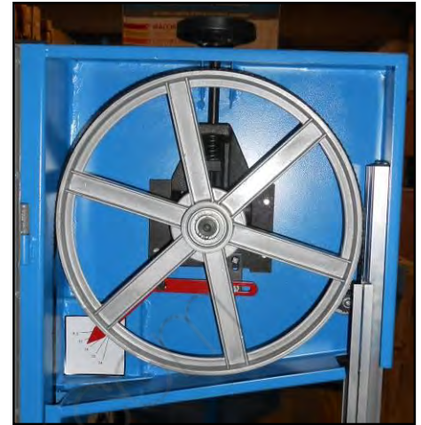
Figura 10 – Regolazione tensione lama.
