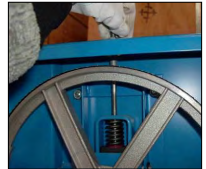
Figura 9 – Regolazione tensione lama.
