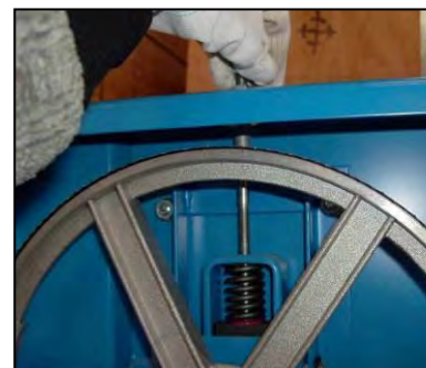
Figura 9 – Regolazione tensione lama.
