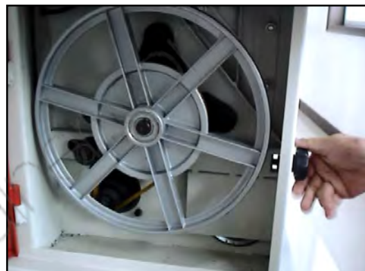
Figura 24 - Allentamento della cinghia di trasmissione.
