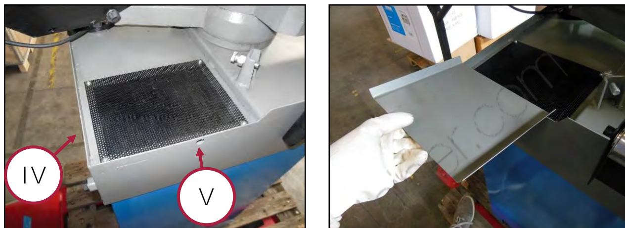
Figura 20 – Installazione della piastra di raccolta del refrigerante.
