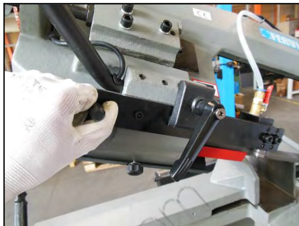
Figura 30 – Regolazione della posizione del guida lama.
