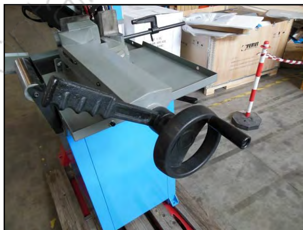
Figura 28 – Regolazione e bloccaggio della morsa.
