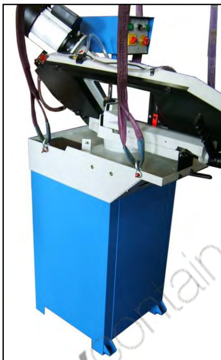
Figura 13 – Sollevamento della macchina.
