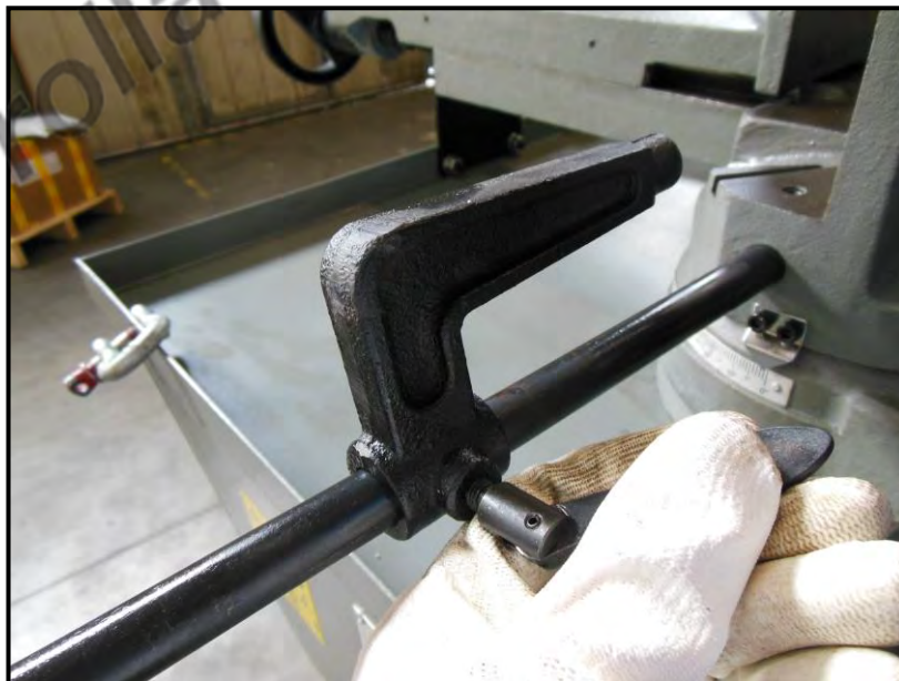
Figura 27 – Regolazione della staffa di riferimento.
