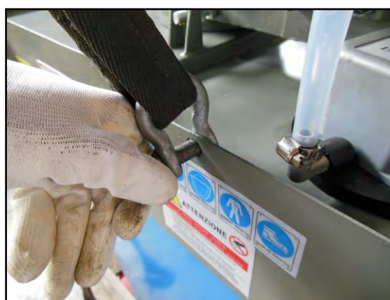
Figura 17 – Dettaglio fissaggio grilli.
