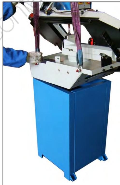
Figura 19 – Allineamento delle due parti.
