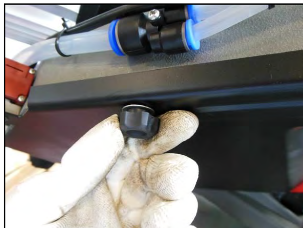
Figura 35 – Apertura carter di protezione.
