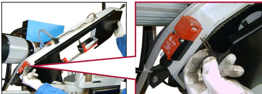
Figura 36 – Smontaggio del carter di protezione lama.
