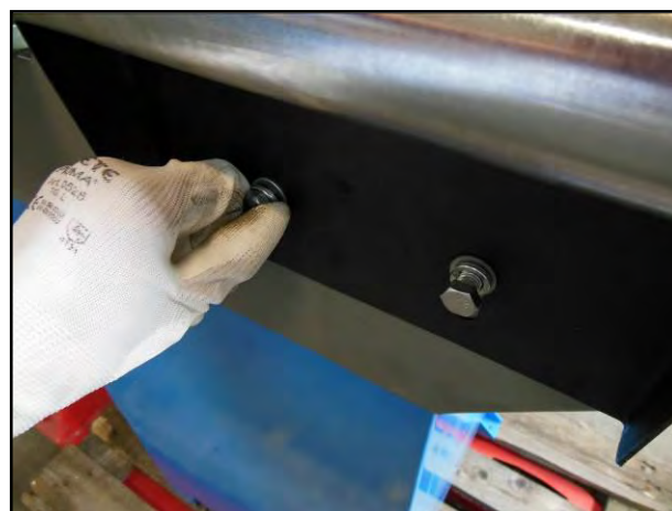
Figura 24 – Installazione del rullo di sostegno dei profilati.
