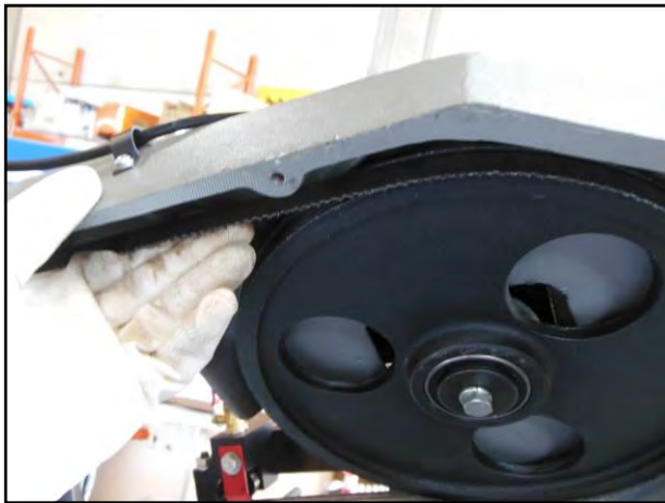
Figura 39 – Montaggio della lama e regolazione della tensione.
