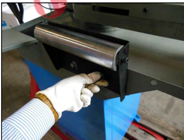
Figura 24 – Installazione del rullo di sostegno dei profilati.
