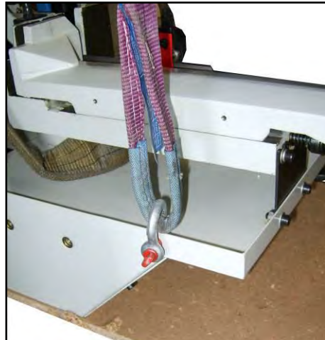
Figura 18 – Sollevamento del basamento della macchina.
