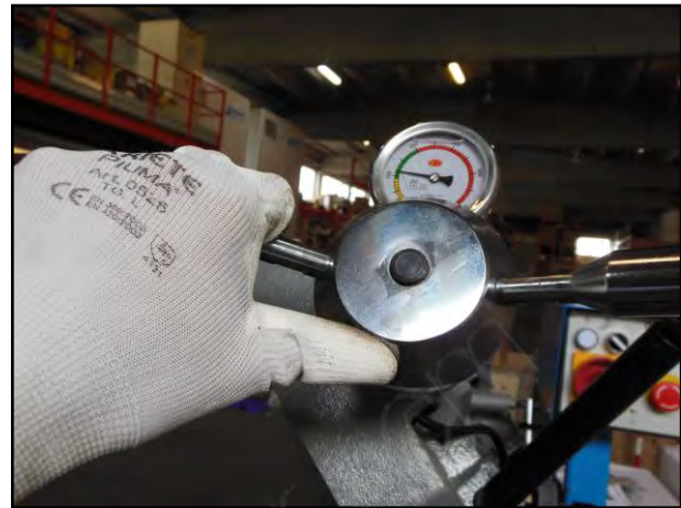
Figura 39 – Montaggio della lama e regolazione della tensione.
