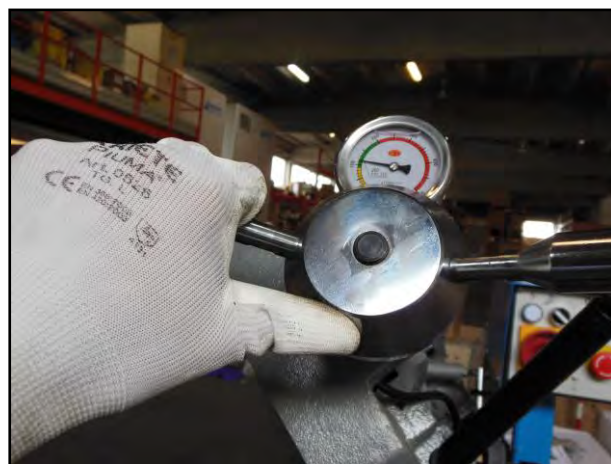
Figura 38 – Riduzione tensione lama.
