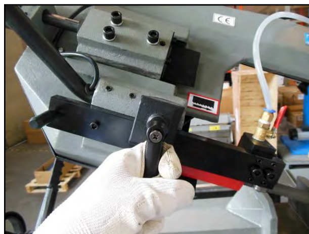
Figura 29 – Sbloccaggio vite del guida lama.
