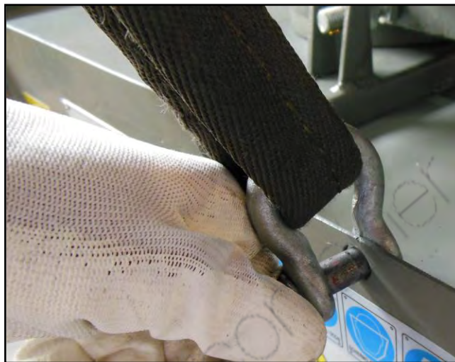
Figura 11 - Dettaglio grillo di sollevamento.
