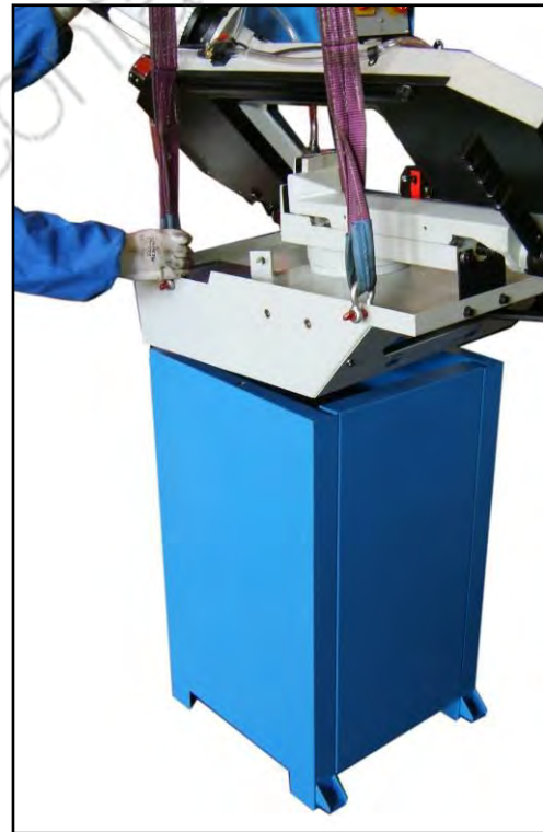
Figura 19 – Allineamento delle due parti.
