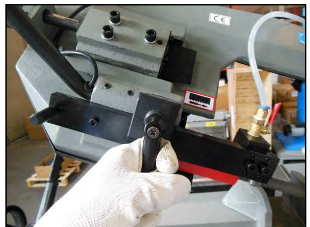
Figura 31 – Sbloccaggio vite del guida lama.
