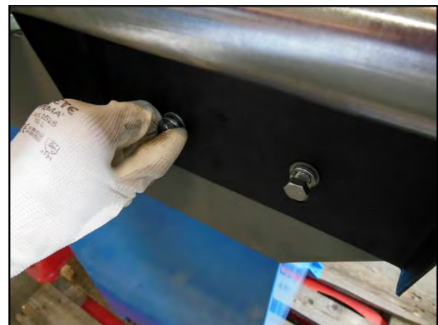
Figura 24 – Installazione del rullo di sostegno dei profilati.
