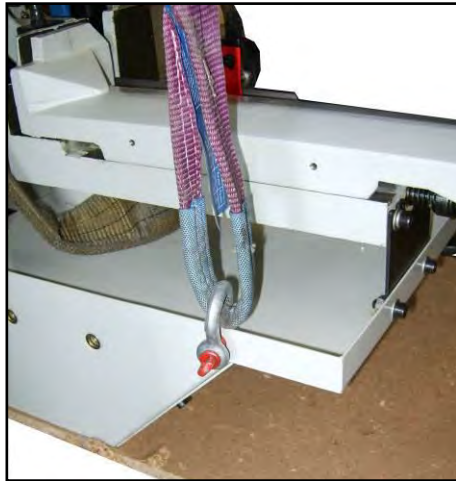
Figura 18 – Sollevamento del basamento della macchina.
