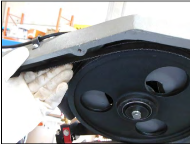
Figura 41 – Montaggio della lama e regolazione della tensione.
