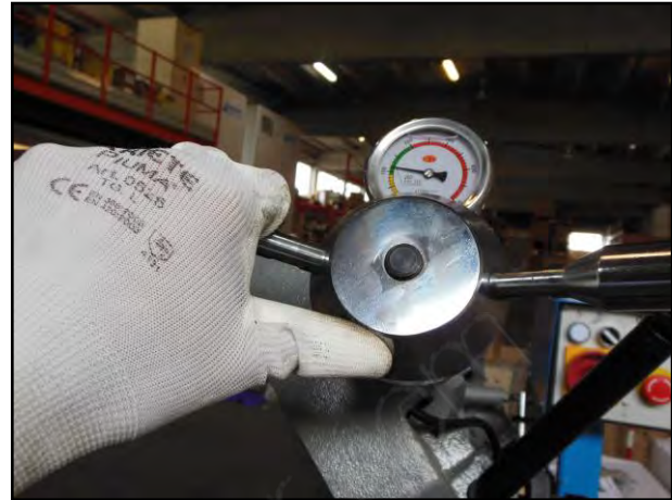
Figura 41 – Montaggio della lama e regolazione della tensione.
