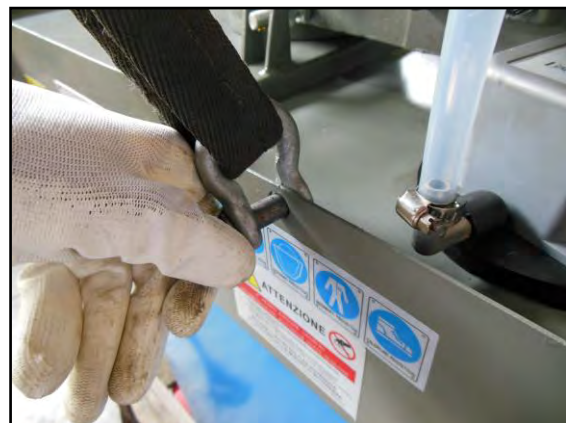
Figura 17 – Dettaglio fissaggio grilli.
