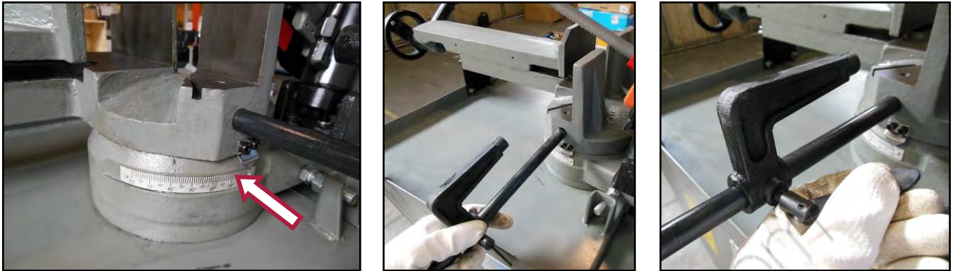
Figura 25 – Installazione dell'asta di riferimento.
