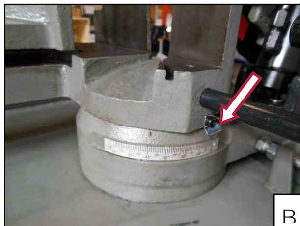
Figura 28 – Regolazione della posizione della testa.
