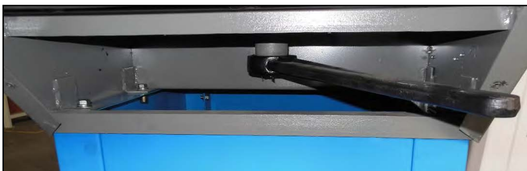
Figura 21 – Fissaggio del basamento alla base di appoggio inferiore.
