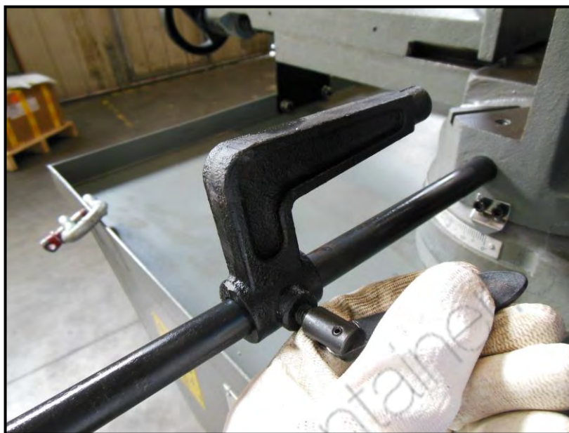
Figura 29 – Regolazione della staffa di riferimento.
