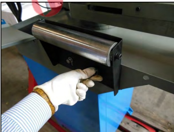
Figura 24 – Installazione del rullo di sostegno dei profilati.
