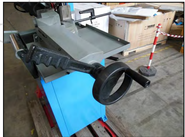
Figura 30 – Regolazione e bloccaggio della morsa.
