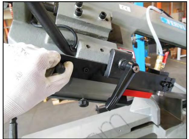
Figura 32 – Regolazione della posizione del guida lama.
