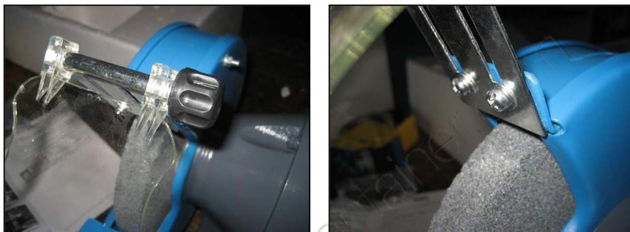
Figura 5 – Montaggio degli schermi di protezione.
