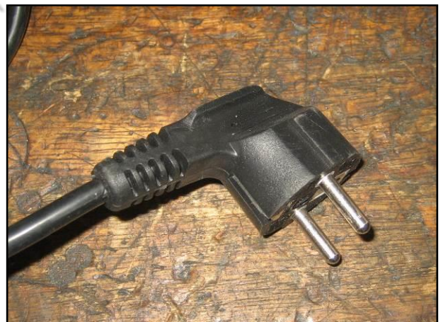
Figura 9 – Particolare spina di alimentazione.
