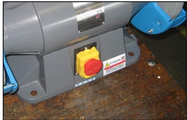
Figura 4 – Dettaglio fori di fissaggio.
