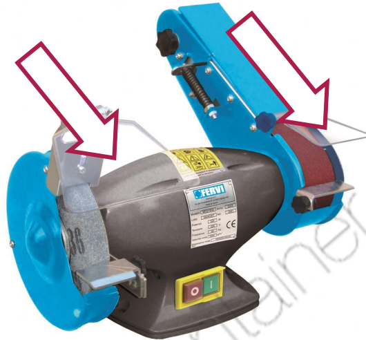
Figura 5 – Dettaglio schermi di protezione.
