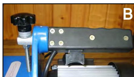
Figura 5 – Pulsanti: di consenso (A) di avviamento (B).
