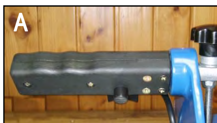
Figura 5 – Pulsanti: di consenso (A) di avviamento (B).
