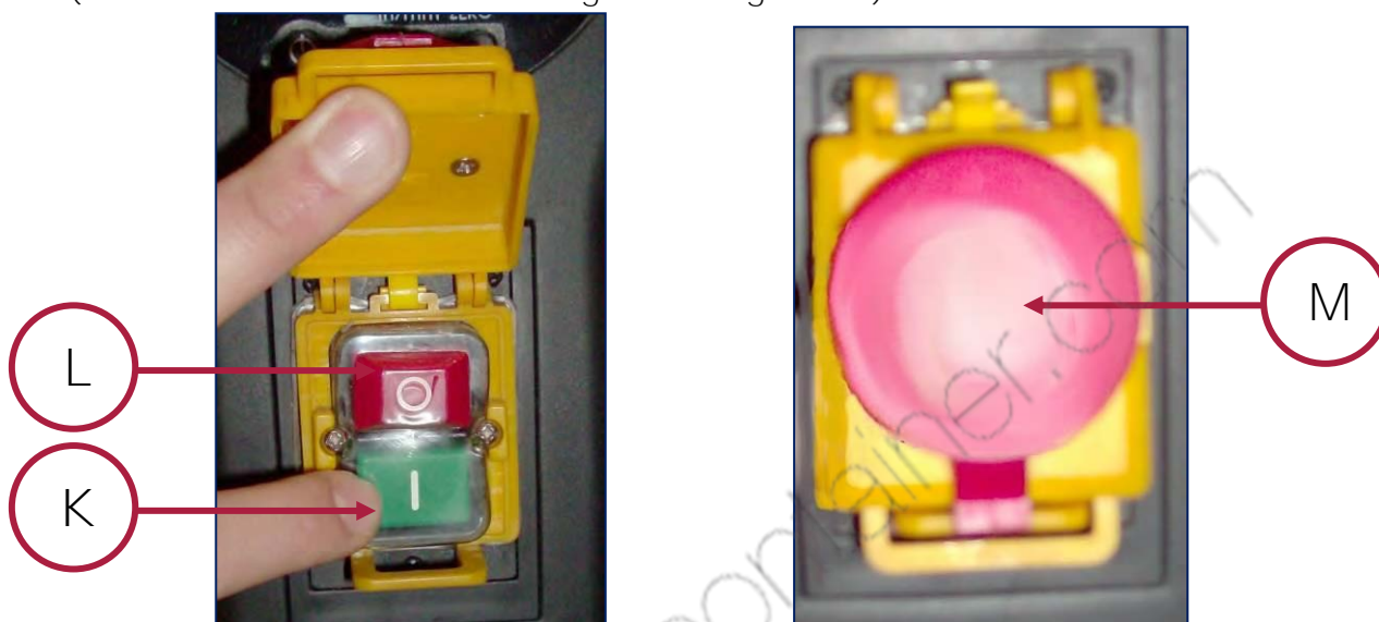
Figura 12 – Pulsante di avvio/arresto e emergenza
