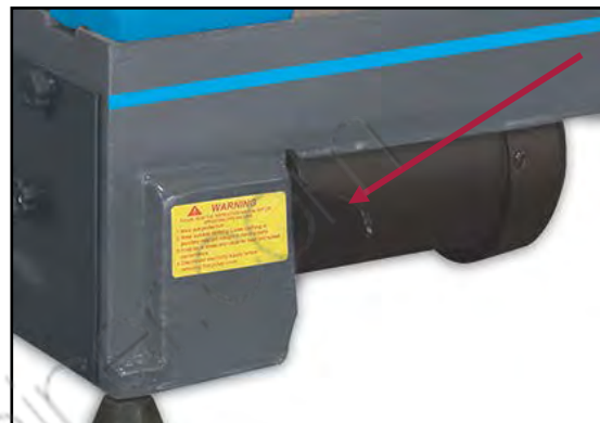
Figura 13 – Leva tensione cinghie
