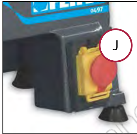
Figura 6 - Quadro di comando.
