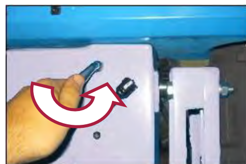
Figura 13 – Allentare la tensione
