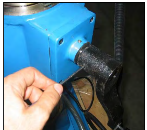
Figura 29 – Smontaggio del mandrino
