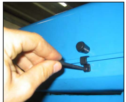
Figura 7 – Svitare la vite del carter
