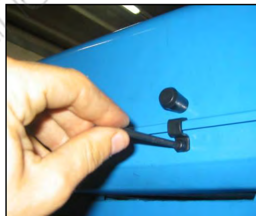
Figura 6 – Svitare la vite del carter
