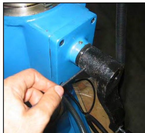
Figura 24 – Smontaggio del mandrino
