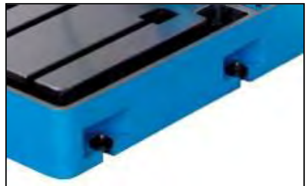
Figura 23 Fori di fissaggio.
