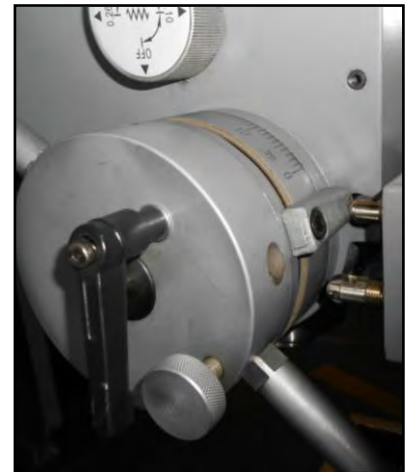
Figura 11 - Blocchetti azionamento micro interruttori.
