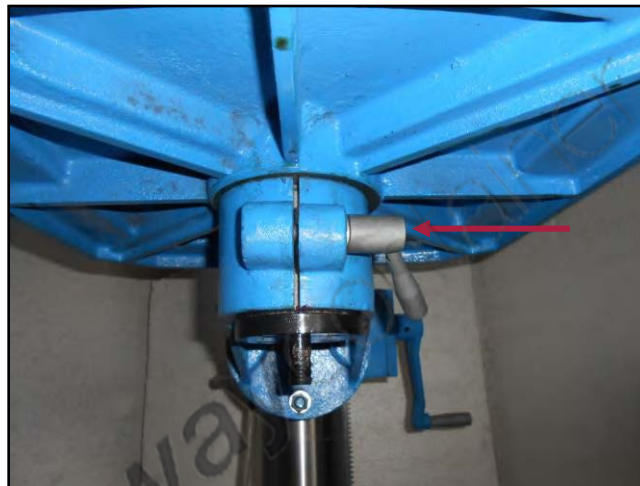
Figura 25 Bloccaggio rotazione orizzontale.
