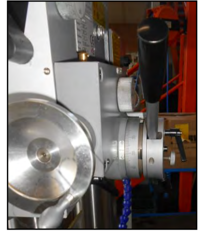
Figura 10 - Ghiera di regolazione avanzamento mandrino.
