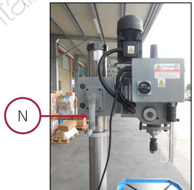
Figura 14 Manovella regolazione testata.
