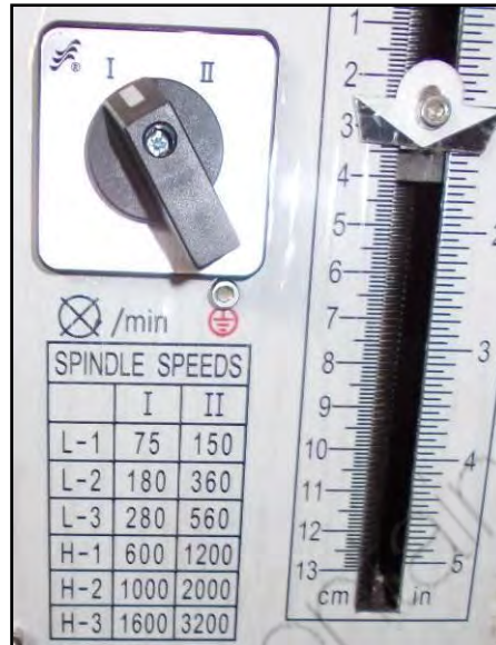
Figura 5 – Targhetta della velocità del mandrino
