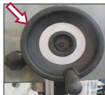
Figura 9 – Volantino avanzamento calibrato.
