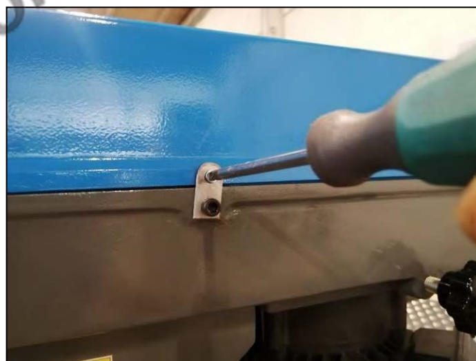
Figura 18 Staffa di chiusura carter pulegge
