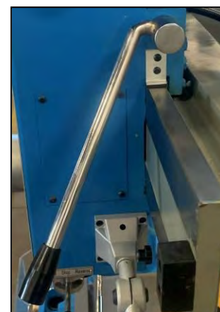
Figura 12 - Leva di blocco movimentazione orizzontale della testa.
