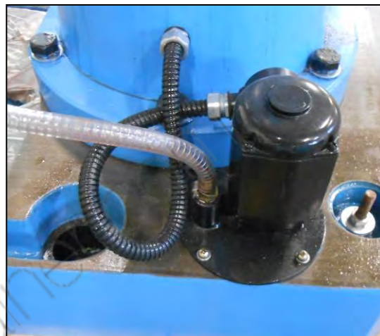
Figura 16 - Motore elettrico di comando della pompa di refrigerazione.
