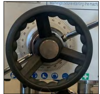
Figura 13 - Volantino di avanzamento orizzontale.
