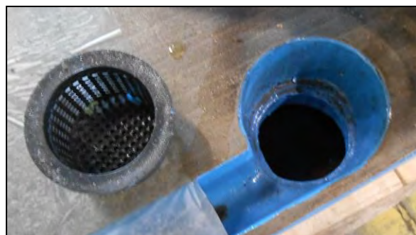
Figura 17 - Foro di ingresso liquido di raffreddamento.
