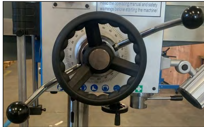
Figura 25 - Volantino di avanzamento e nonio posteriore.
