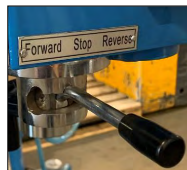
Figura 8 – Selettore di comando per la regolazione del senso di rotazione del mandrino.
