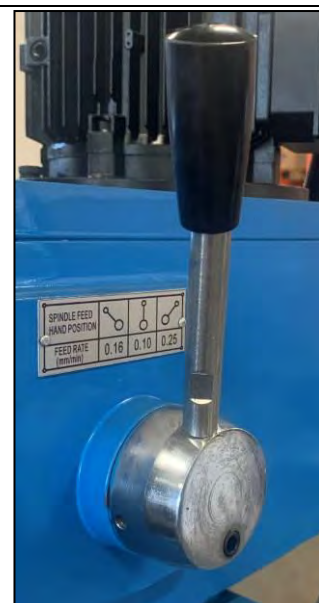
Figura 10 - Leva di regolazione della velocità di avanzamento verticale del mandrino.
