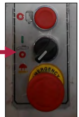
Figura 18 - Selettore per l'attivazione della pompa di aspirazione del liquido refrigerante.
