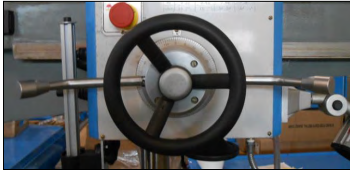
Figura 26 - Volantino di avanzamento e nonio posteriore.
