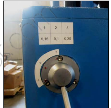
Figura 10 - Leva di regolazione della velocità di avanzamento verticale del mandrino.
