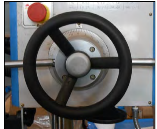
Figura 13 - Volantino di avanzamento orizzontale.
