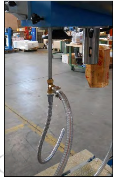
Figura 19 - Zona terminale del circuito di raffreddamento con rubinetto.
