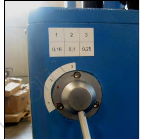
Figura 12 - Leva di blocco movimentazione orizzontale della testa.
