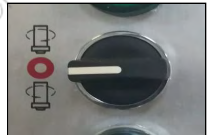
Figura 8 - Selettore di comando per la regolazione del senso di rotazione del mandrino.
