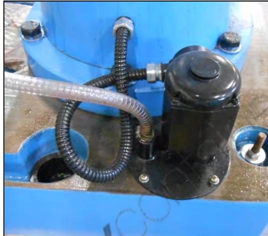
Figura 16 - Motore elettrico di comando della pompa di refrigerazione.
