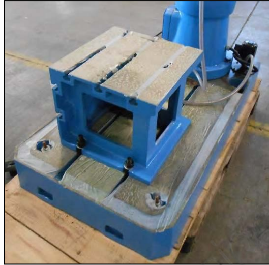
Figura 24 – Fissaggio al pavimento.
