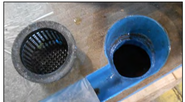
Figura 17 - Foro di ingresso liquido di raffreddamento.
