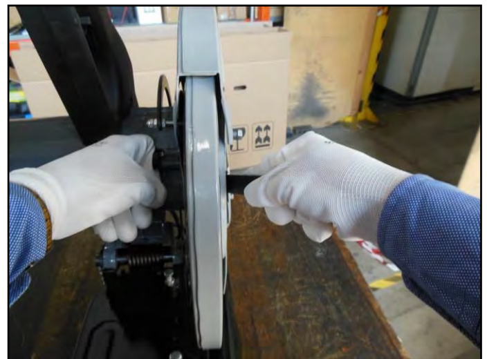
Figura 15 – Rimozione dado di blocco del disco.
