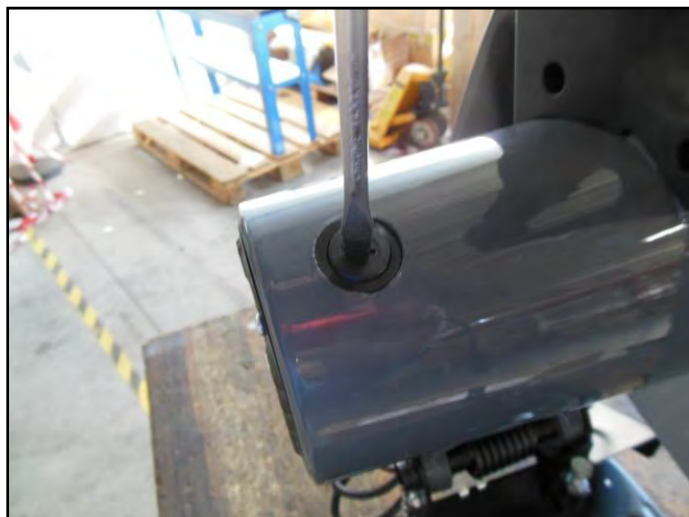
Figura 12 – Sostituzione delle spazzole.
