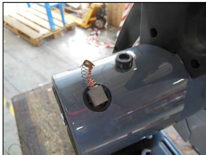
Figura 12 – Sostituzione delle spazzole.
