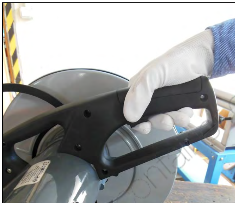
Figura 4 – Azionamento degli interruttori.
