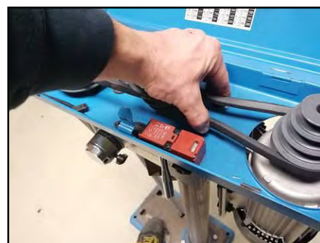
Figura 45 – Corretto tensionamento delle cinghie
