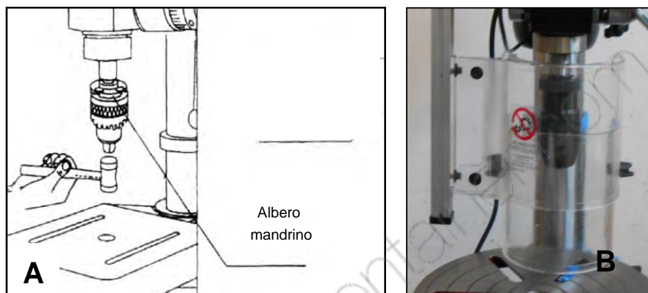
Figura 8 - mandrino (A: battere col martello - B: vista d'insieme).
