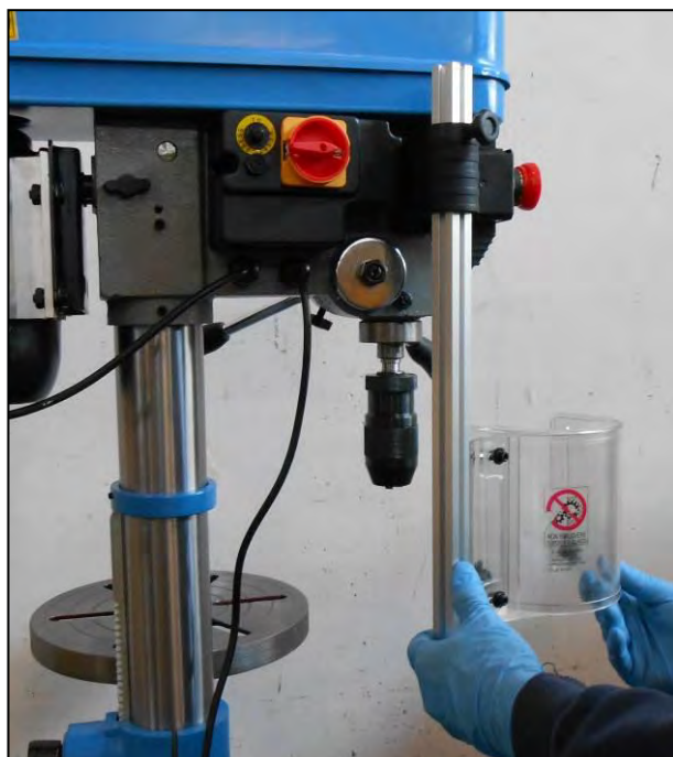
Figura 17 – Inserimento della staffa e posizionamento corretto del riparo
