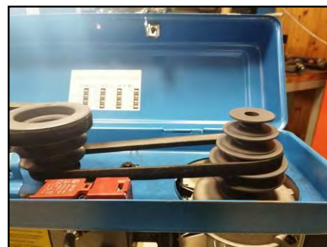
Figura 46 – Montaggio errato delle cinghie
