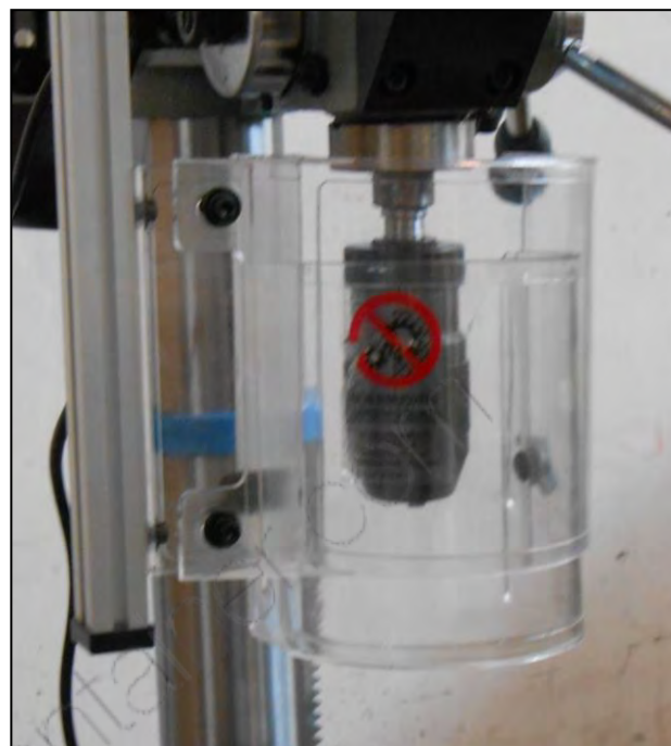
Figura 17 – Inserimento della staffa e posizionamento corretto del riparo
