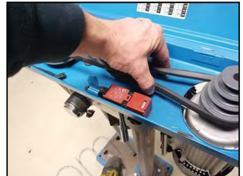
Figura 29 – Corretto tensionamento delle cinghie
