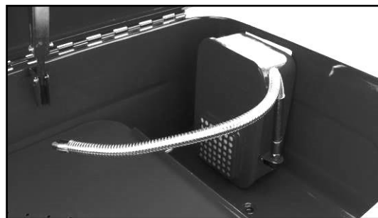
Figura 8 – Montaggio della pompa.
