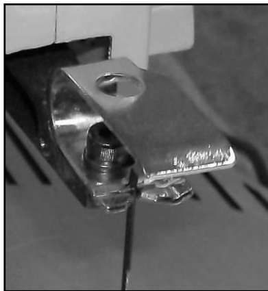
Figura 21 – Montaggio lama (perno superiore).
