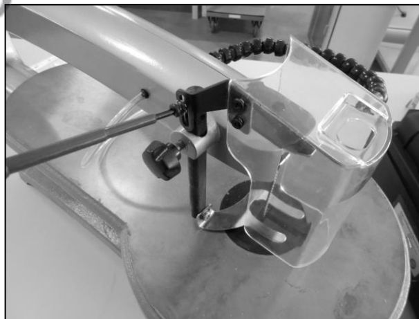
Figura 18 – Smontaggio del carter lama
