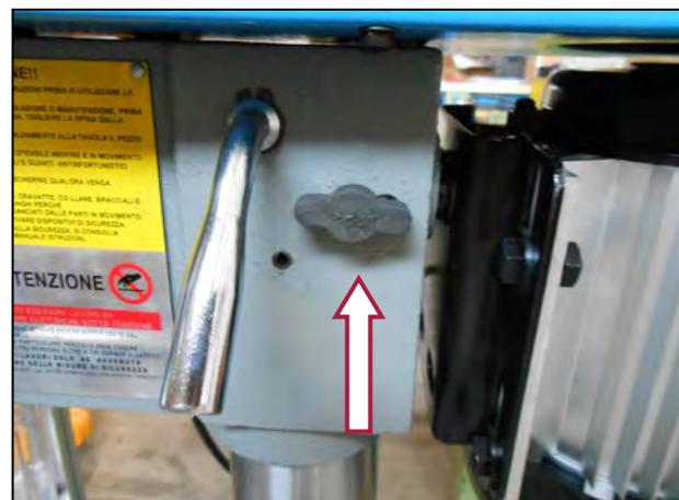
Figura 27 – Leve di bloccaggio.
