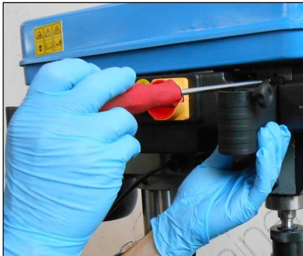
Figura 10 – Montaggio del blocco microinterruttore
