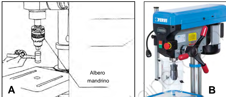
Figura 8 - mandrino (A: battere col martello – B: vista d'insieme).
