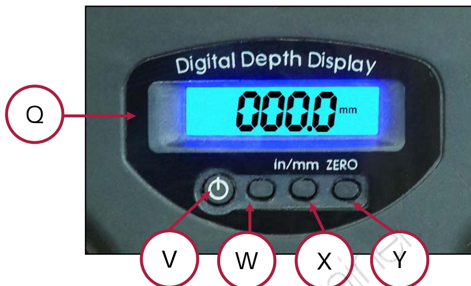
Figura 29 – Visualizzatore discesa mandrino
