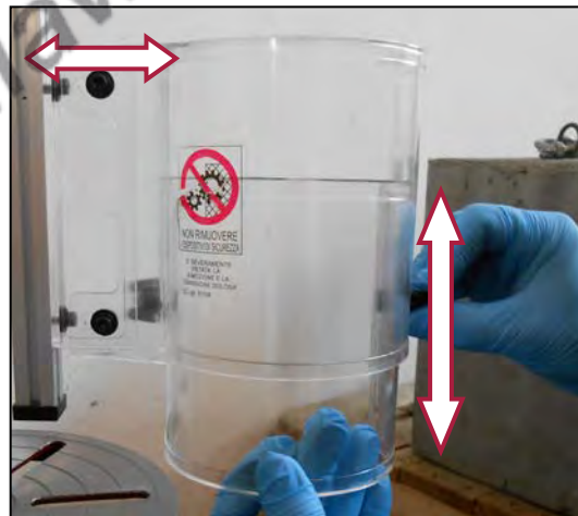
Figura 42 - Scorrimenti del riparo in senso verticale e longitudinale
