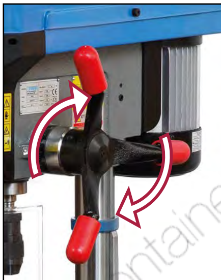
Figura 35 – Volantino di avanzamento.
