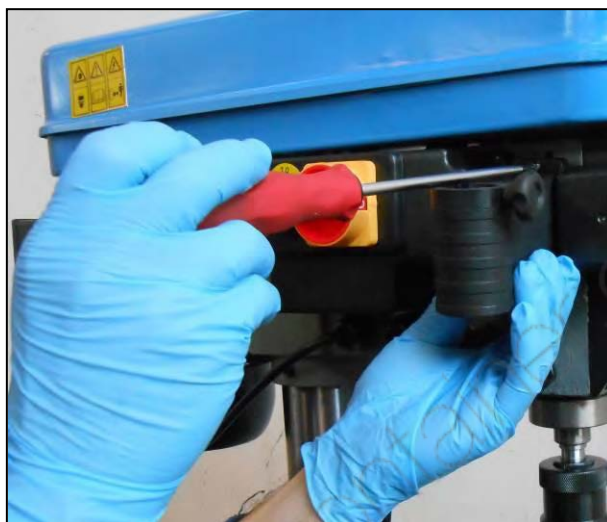
Figura 14 – Montaggio del blocco microinterruttore
