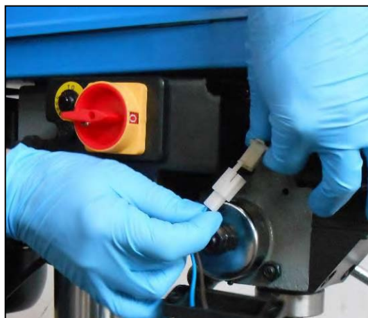
Figura 13 – Collegamento delle connessioni
