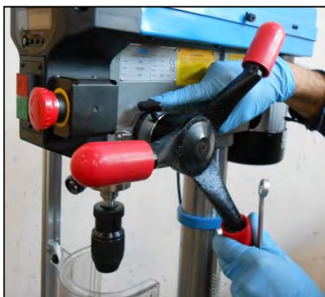
Figura 34 – Vite di blocco corsa mandrino.
