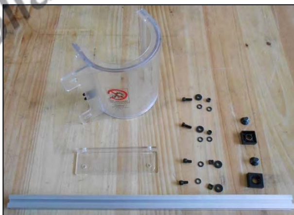
Figura 15 – Parti per il montaggio del riparo
