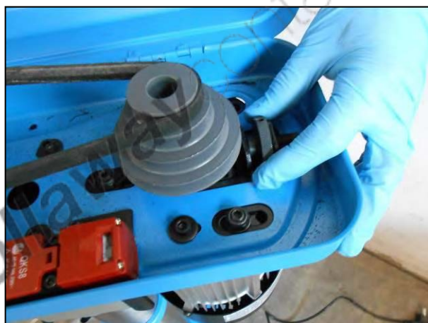
Figura 30 – Manopola di tensionamento
