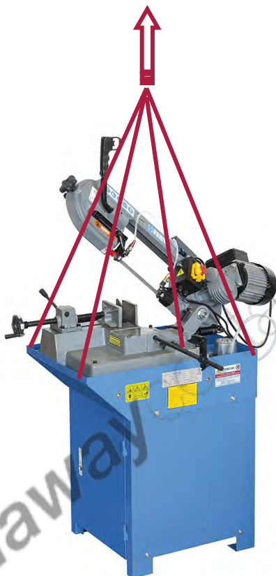
Figura 14 – Sollevamento con gru o carroponte
