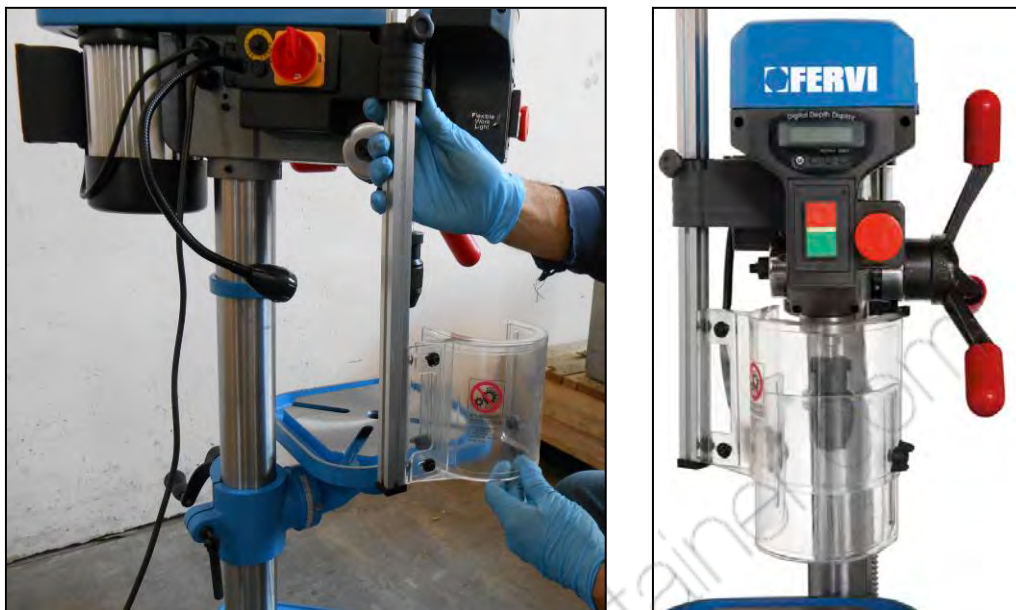
Figura 20 – Inserimento della staffa e posizionamento corretto del riparo
