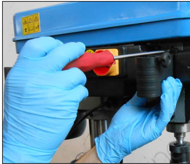
Figura 14 – Montaggio del blocco microinterruttore
